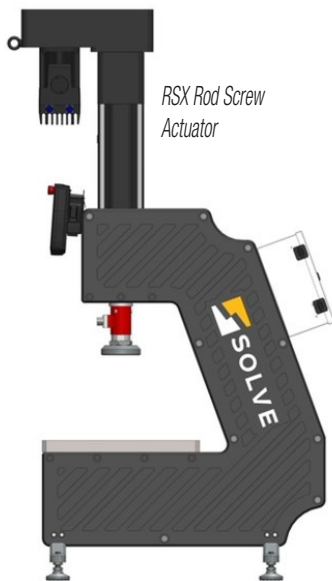
La E-Press SLV-60 con actuador Tolomatic RSX es una de las diversas servoprensas lineales prediseñadas que pueden configurarse para satisfacer requisitos de aplicación específicos y exigentes.
